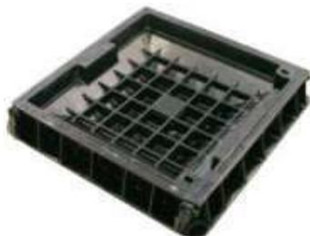
**Chiusino 60x60** a riempimento in ghisa sferoidale classe D 400 (rispondente alla norma EN124). Permette il riempimento con qualsiasi tipo di materiale (porfido, basoli, granito), in modo da mantenere la continuità della pavimentazione.
