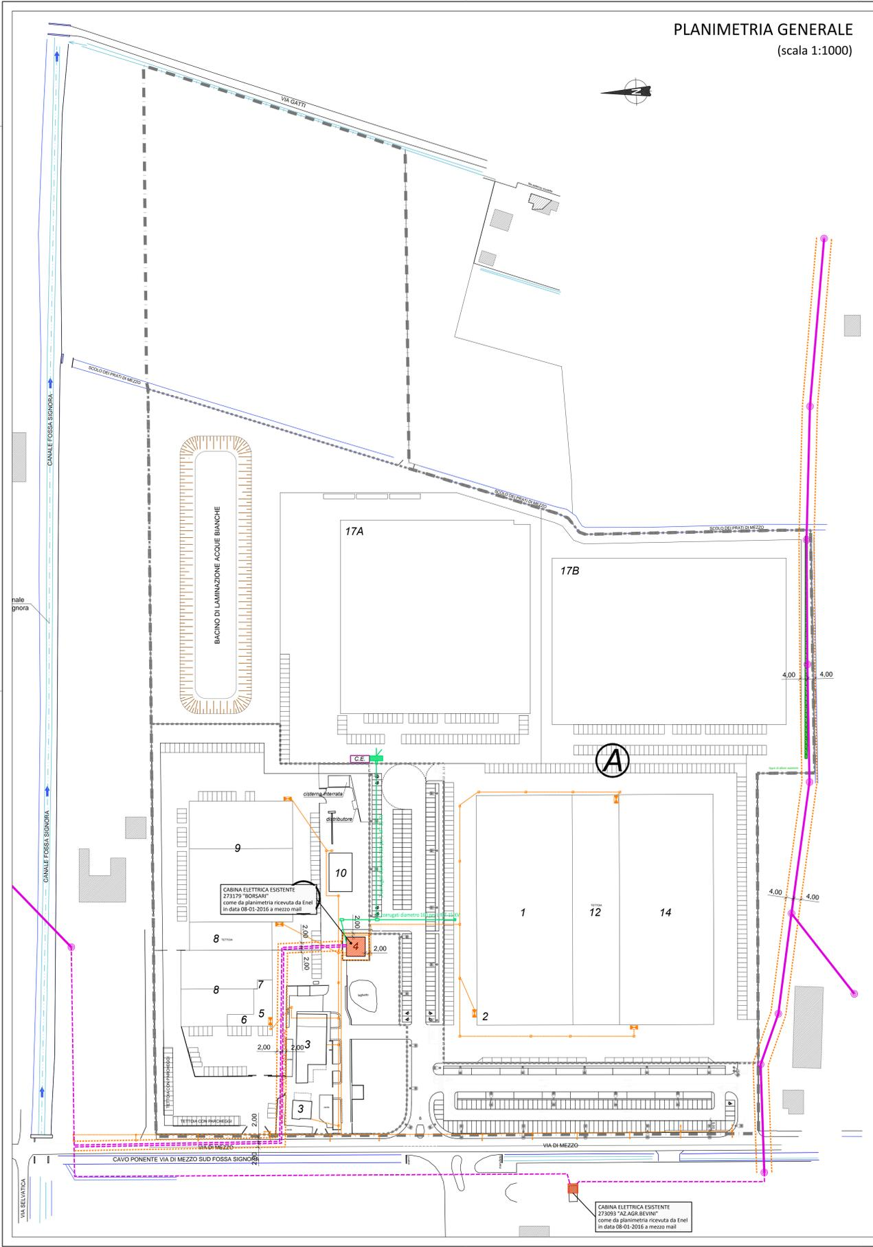
ELABORATO RICEVUTO DA ENEL CON INDIVIDUAZIONE DELLE LINEE ELETTRODOTTO ESISTENTI E IDENTIFICAZIONE DELLE CABINE ENEL ESISTENTI
