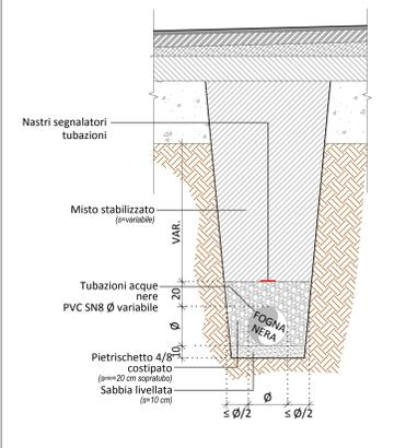
N.B. La rete acque nere dovrà essere posizionata ad est della rete acque bianche lungo l'asse viario principale al fine di ottimizzare le intersezioni con altre reti. La posizione reciproca delle reti dovrà in ogni caso essere concordata con la Direzione Lavori in fase di cantiere.
