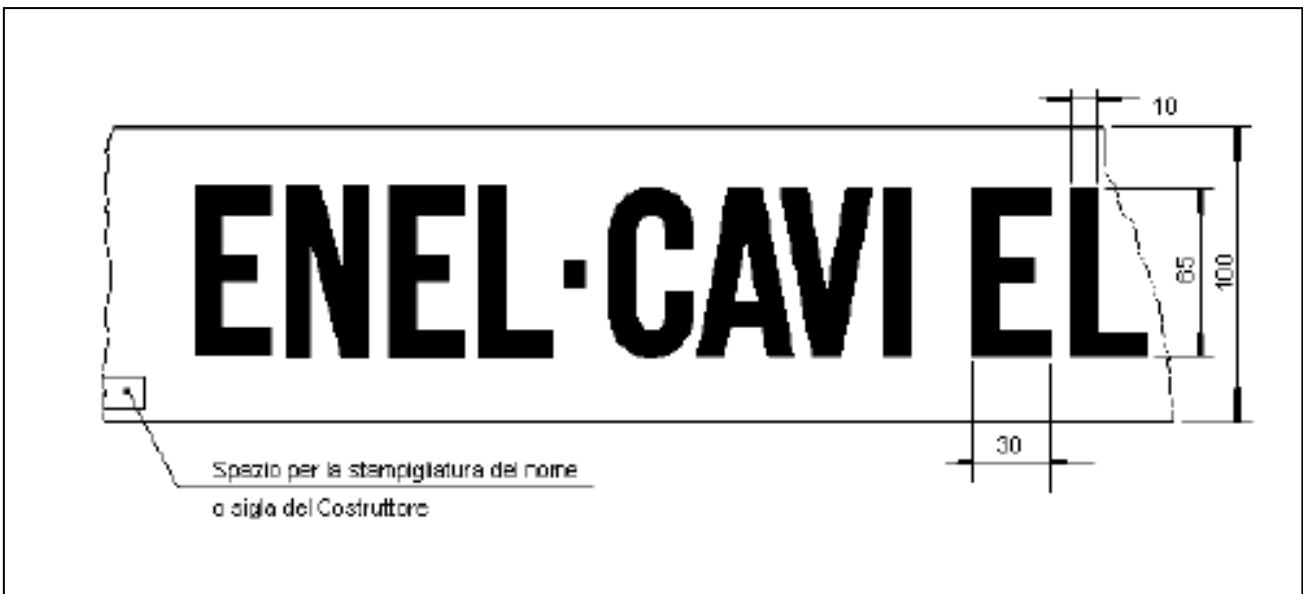
Figura 8 – Nastro di segnalazione
